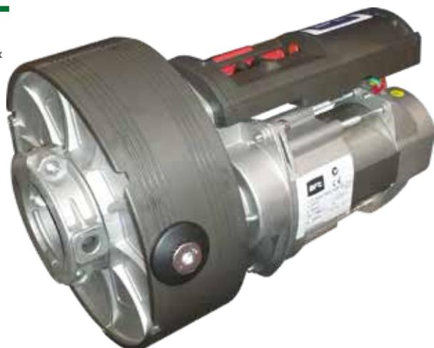
Operadores de 230 V para cierres metálicos enrollables con par de hasta 445 Nm. Idóneos para el montaje en cierres metálicos con polea de diámetro 200, 220, 240 y 280 mm y eje de diámetro 42, 48, 60, 76 y 101 mm. Disponibles en versiones con o sin electrofreno.
